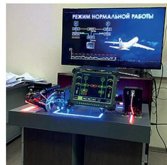
Рисунок 2 - Демонстратор интеллектуальной системы электроснабжения летательного аппарата
